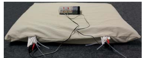
Schnittstelle für Drucksensoren und Atemluftschläuche
